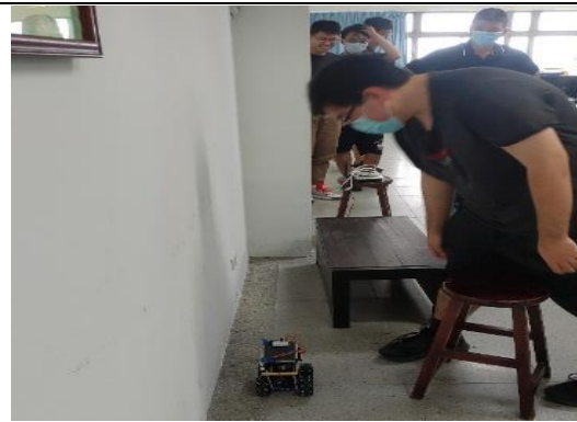
電機系物聯網應用實務與實作課程 學生實作展演-麥克納姆輪車完成以 定距離沿牆壁直行以及可跟隨行走 這二項功能
