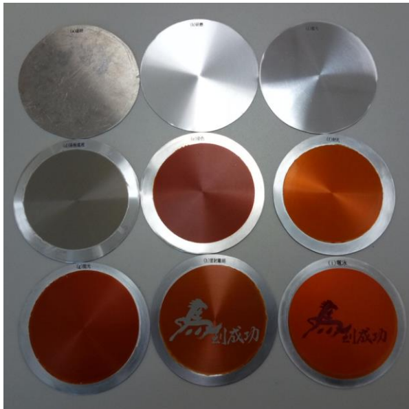
圖一、6061 鋁合金表面陽極處理與圖案化步驟 圖二、6061 鋁合金陽極處理實際照片；電流密度:1~12A/dm 2 、50cm 2 、22 °C、20min
