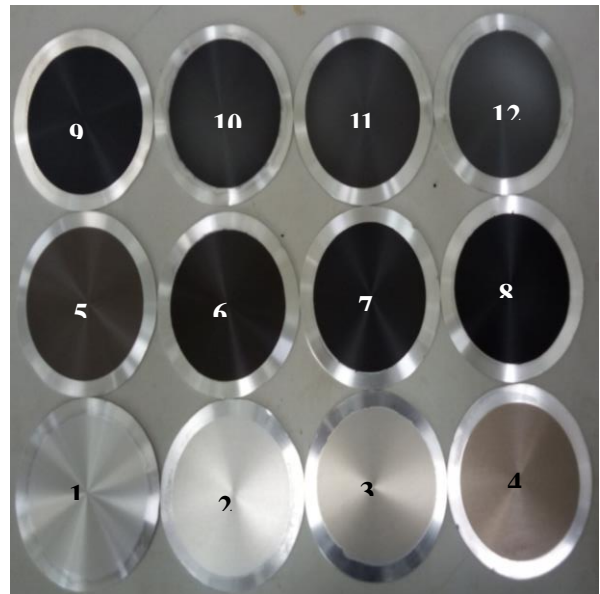
圖一、6061 鋁合金表面陽極處理與圖案化步驟 圖二、6061 鋁合金陽極處理實際照片；電流密度:1~12A/dm 2 、50cm 2 、22 °C、20min
