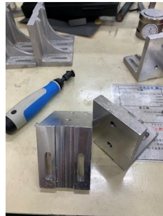
圖四、實習時間回學校所製作的零件，它是鋁鑄造件，需要兩面 90 度的加工，用於沖床移送桿上。
