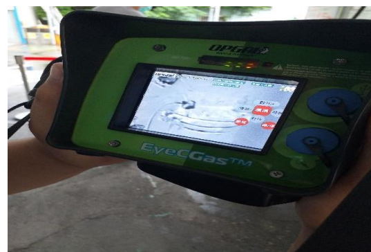
圖四、紅外線熱像儀—能將這些人眼無法看到的輻射能量轉換為電訊號，並以各種不同的顏色來顯示出不同溫度的分佈，使整個溫度分布狀態以可視圖像顯示出來。
