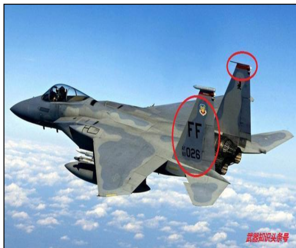
圖二、簡稱平尾，是飛機縱向平衡、穩定和操縱的翼面。平尾左右對稱地布置在飛機尾部，基本為水平位置。翼面前半部通常是固定的，稱為水平安定面。後半部鉸接在安定面的後面，可操縱上下偏轉，稱為升降舵。
