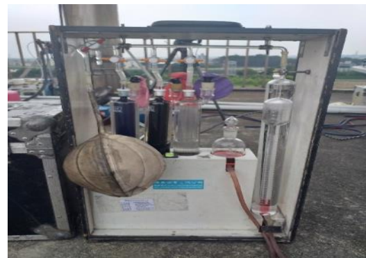
圖二、ORSAT—用於測定排放管道中氣體組成，包括二氧化碳、氧氣及一氧化碳三種氣體，合計氣體體積在 0.2~30%範圍。
