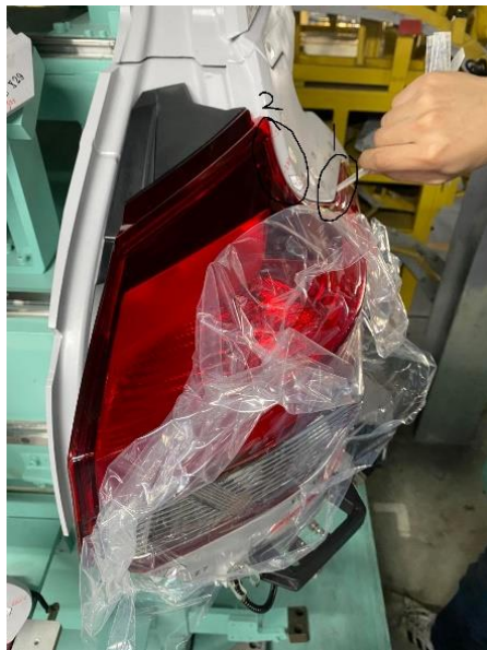
圖三、將尾燈上置檢具上量測 (圖中1為間隙過大、2為干涉地方)
