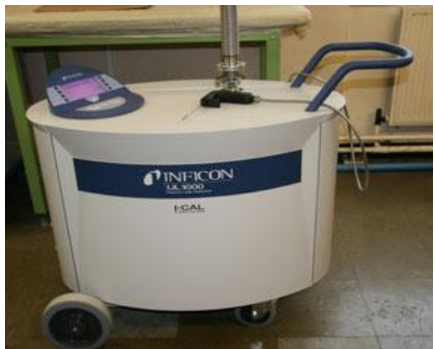
圖四、內容有提到的氦測機，管線會連接到 chamber 內，氦測機會先將連接管線抽真空，再開腔室的手動閥，此時再用氦氣鋼瓶對著各個零件噴，如果氦氣被吸進去，這台機器上方螢幕的數值就會突然飆升，就知道哪裡有漏。
