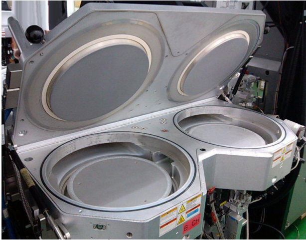
圖一、PECVD Producer chamber 內部照片，晶圓會從右邊的 Buffer robot 抓近來並且在這個腔室內沉積薄膜
