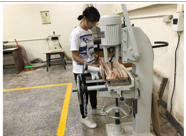
鑿孔機協助打洞
