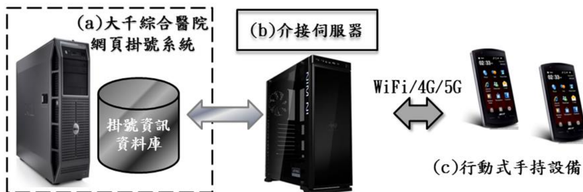
圖一、行動掛號與看診號查詢系統架構圖
